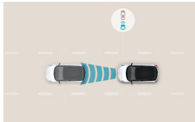
Spurfolgeassistent (LFA) Ist der Spurfolgeassistent aktiviert, bleibt das Fahrzeug mittig in der Fahrspur.
