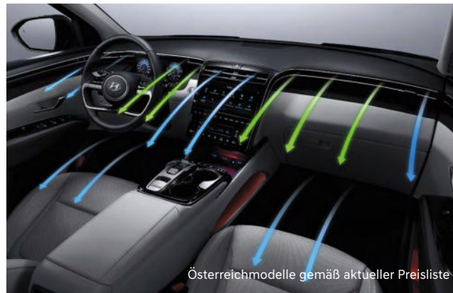
Multi-Air-Modus mit indirekten Lufteinlässen
